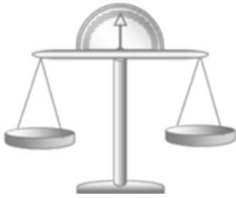
Figura 1.5. La masa se mide por medio de la balanza de brazos iguales.
