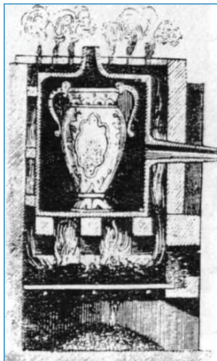
Antiguo borno de mufla (alimentado a carbón) para decorar porcelana. Los colores de decoración requieren de una atmósfera purísima. Una buena mufla aísla la pieza del humo. Los modernos bornos eléctricos no requieren mulla.
