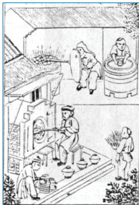
Antiguo borno chino para porcelana. Obsérvense las casetas y las diminutas leñas. Al fondo (izq.) calcinado feldespatos; y (der) trabajando en el torno.
