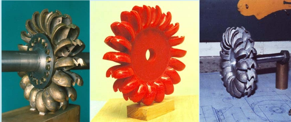
Figuras 1, 2 y 3. Rotores de turbinas Pelton de bronce, poliuretano rígido y aluminio fabricados en el iih. Fuente: Prog. Hidroenergía. IHH-UMSA
