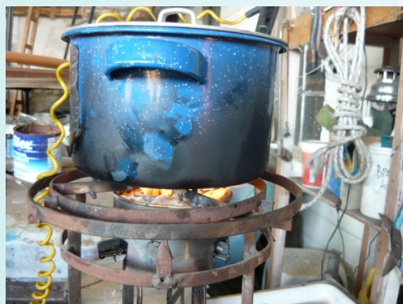
Fotografía 2. Pruebas de eficiencia utilizando olla de cocción
