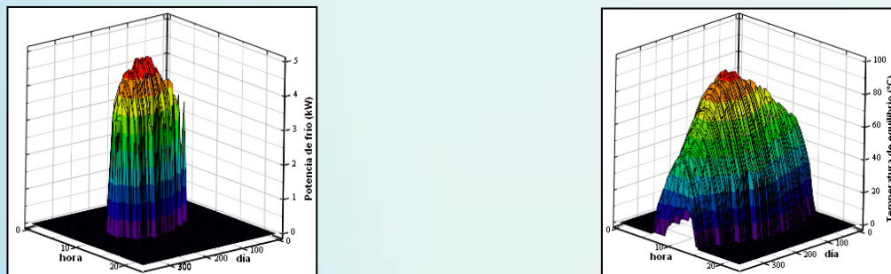
Figura 2. (izq.) Potencia horaria de frío (kW) a lo largo de un año. (dech.) t_{\text{geq.}} ( t_e=5^\circ\text{C} )
